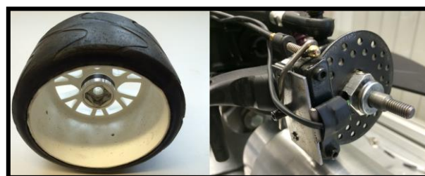
Abbildung 2 • Rad mit Magnetring (links), Scheibenbremse mit Drehzahlsensor (rechts)
